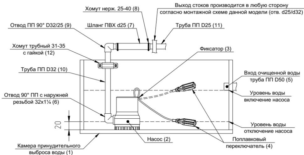
В камеру принудительного выброса очищенной воды (1) устанавливается погружной насос (2). Поплавковый переключатель (4) закрепляется в фиксаторе (3), установленном на насосе (2). Ход поплавкового переключателя (4) должен находиться в свободном положении, для обеспечения беспрепятственного всплытия (включая насос), и опускаться (отключая насос). Поплавковый переключатель (4) на включение насоса (2) устанавливать строго по уровню низа лотка входящей трубы Ø50 мм (5) (см. схему).
