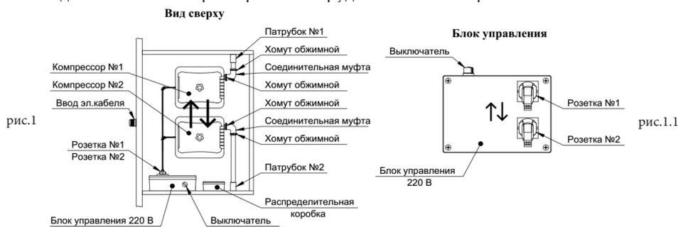
**По завершению процедуры замены убедитесь в надежности подключения соединительных муфт и фиксации обжимными хомутами. Несоблюдение порядка подключения оборудования ведет к неправильной работе УОСВ.**
