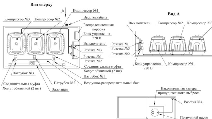
Рис. №8. УОСВ ТОПАС 75 ПР с принудительным выбросом очищенной воды
