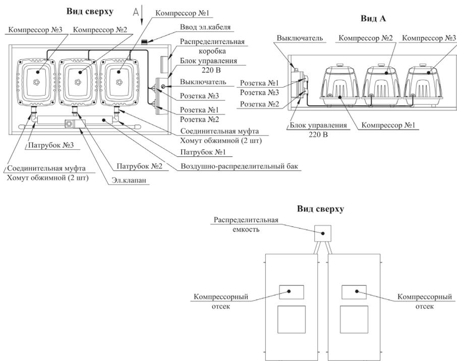
Рис. №11. УОСВ ТОПАС 150 с самотечным отводом очищенной воды
